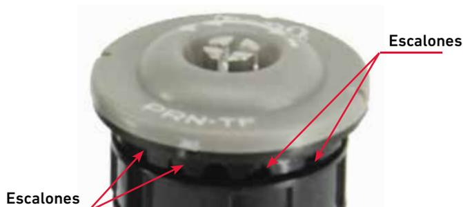
La tecnología Step-Up™ está diseñada para ofrecer una alta uniformidad de pluviometría desde el centro del arco hasta el punto más alejado del radio. Los exclusivos "escalones" crean 15 chorros, cada uno diseñado para cubrir una zona determinada del arco.
