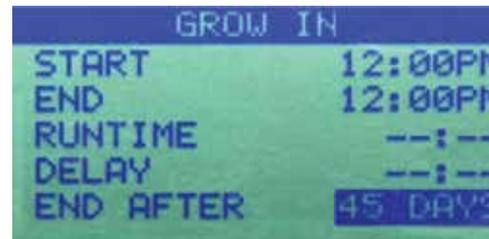
La pantalla de **Enraizamiento** permite establecer una hora de riego de enraizamiento durante un periodo de tiempo definido por el usuario de hasta 90 días. Después de este periodo, el programador volverá a las horas de riego normales.
