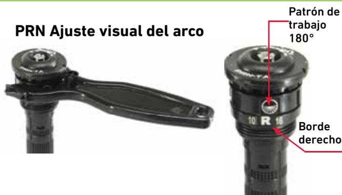
El exclusivo método de ajuste permite preestablecer el arco a mano o con la herramienta antes de instalar la boquilla. Unos indicadores visuales permiten al usuario ajustar rápidamente el arco deseado entre 45° y 270°. La banda de ajuste puede modificarse a mano o con la herramienta incluida. La herramienta puede pedirse por separado como: PRNTOOL
