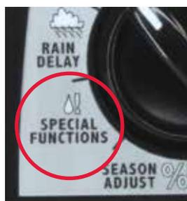
La función Retardo bomba permite establecer un retardo entre la activación de la válvula maestra o la bomba, y la primera válvula, para dar tiempo a que se presurice la línea de riego principal. La función Recuperación de pozo/Retardo estación proporciona un retardo ajustable entre estaciones para compensar el cierre lento de las válvulas o la recuperación del pozo; asimismo es posible energizar o no la Válvula Maestra/Bomba durante el retardo.
