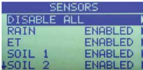
Por ejemplo, la pantalla **Aplicar sensores** permite ver y configurar fácilmente todos los sensores disponibles en el programador, incluyendo lluvia, ET y suelo.
