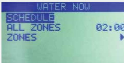
Por ejemplo, la pantalla **Regar** permite iniciar el riego pulsando tan solo dos botones, con la opción de usar un plan de riego específico, una zona determinada, o regar todas las zonas una tras otra.
