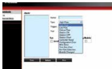
El sistema TriComm puede enviar mensajes de correo electrónico o SMS para alertar al usuario en tiempo real sobre condiciones de alarma (caudal, fusibles, etc.), o sobre operaciones estándar (Estación activada, etc.).
