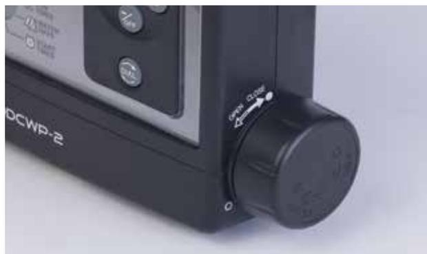
La tapa roscada facilita la instalación de las dos baterías de 9 V. La tapa de la batería constituye un cierre estanco fiable que permite la sumersión hasta 1,9 m, de acuerdo con la norma IP-68.
