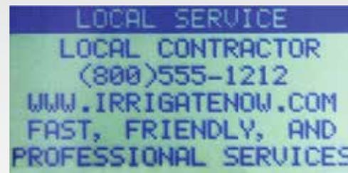
La pantalla **Asistencia local** permite al contratista introducir en el programador un mensaje personalizado con su nombre y datos de contacto, usando el software y un dispositivo USB; este mensaje aparece cuando el usuario pulsa el botón de "Ayuda".
