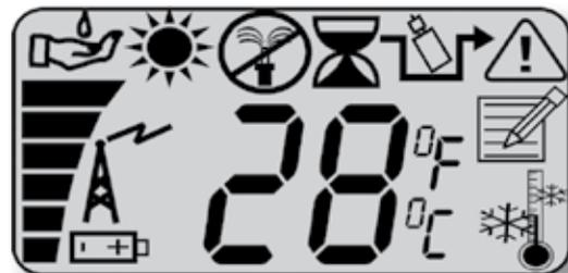
Proporciona información sobre el sistema, incluyendo la temperatura al aire libre, así como la potencia de la señal y el estado de la batería.
