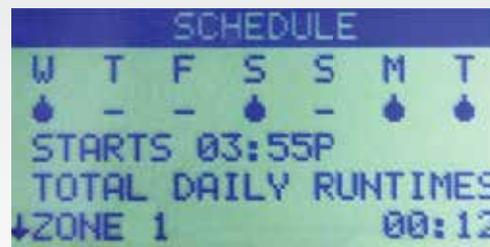
Otro ejemplo es la pantalla **Revisar**, un resumen rápido que muestra los días de riego programados para los próximos siete días para el plan de riego seleccionado.
