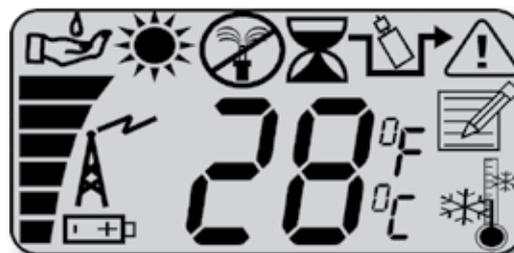
Fournit un feedback système instructif, comprenant la température extérieure, l'intensité du signal de l'émetteur et la durée de vie de la pile
