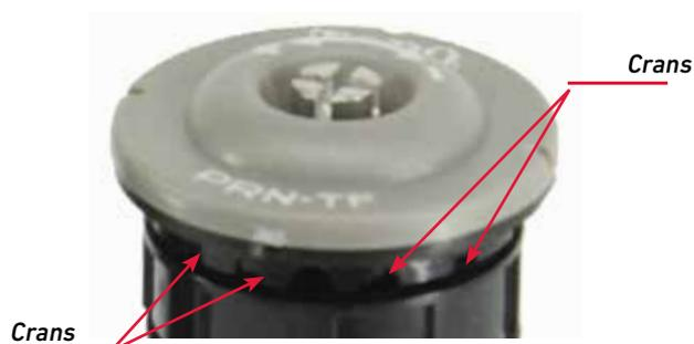
La technologie Step-Up™ est conçue pour offrir une excellente uniformité avec une pluviométrie adaptée, de la plus faible distance d'arrosage jusqu'à la plus grande portée. Les "crans" exclusifs créent 15 jets, chacun conçu pour couvrir une zone du secteur d'arrosage.
