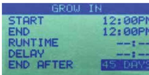
L'écran **Enracinement** permet à l'utilisateur de programmer un cycle d'arrosage répété pendant une durée définie par l'utilisateur (jusqu'à 90 jours), après quoi le programmeur reprend par défaut le ou les cycles d'arrosage normaux.
