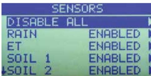
Par exemple, l'écran **Appliquer capteurs** permet à l'utilisateur de visualiser et configurer facilement tous les capteurs disponibles pour le programmeur, y compris les pluviomètres, capteurs ET et sondes de sol.
