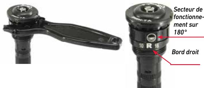
Cette méthode de réglage unique permet de pré-régler le secteur à la main ou avec un outil avant l'installation de la buse. Les indicateurs visuels permettent à l'utilisateur de régler rapidement le secteur d'arrosage sur l'angle désiré, entre 45 et 270°. La bande de réglage se règle à la main ou avec l'outil fourni. L'outil peut être commandé séparément sous la référence suivante : PRNTOOL
