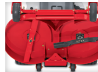
SISTEMA DE REDUÇÃO DE ENCHIMENTO Muda de 100% de recolha em depósito para 50% reciclagem e 50% de recolha em depósito, de forma a que a tremonha possa ser despejada menos frequentemente.
