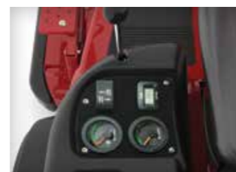
CONTROLOS DE FÁCIL ACESSO Elevação hidráulica, ponta hidráulica para descarga e ajuste da altura de corte a partir do banco do operador.
