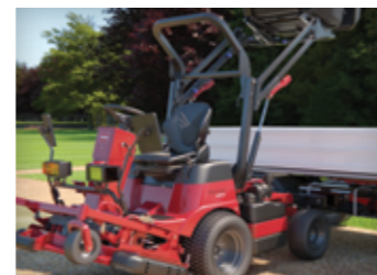
ALTURA DE DESCARGA ATÉ 1,95 M O Proline H800 despeja aparas sem esforço.
