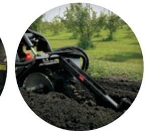
CABEZAL DE ZANJADORA DE ALTA VELOCIDAD
