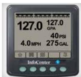
CON EL SISTEMA DE CONTROL DE APLICACIÓN EXCELRATE™ se logran tasas de aplicación precisas de un modo sencillo y repetible. Las dos tasas de aplicación más habituales se calibran paso a paso y se guardan en memoria, ahorrando tiempo y aumentando la precisión. Desarrollado por Toro exclusivamente para el césped y de serie en todas las máquinas Multi Pro 5800.
