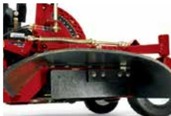
Kit de conducto de descarga controlado por el operario
