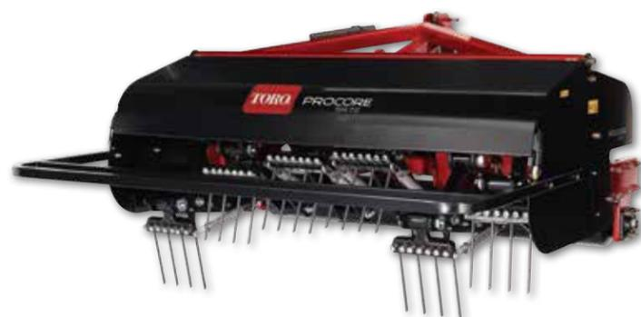
La serie ProCore SR ofrece anchuras de trabajo de 122 a 190 cm (48"-75"), profundidades de trabajo de hasta 40,6 cm (16") y espaciado de las perforaciones de 6,3 a 15,2 cm (2,5"-6").
