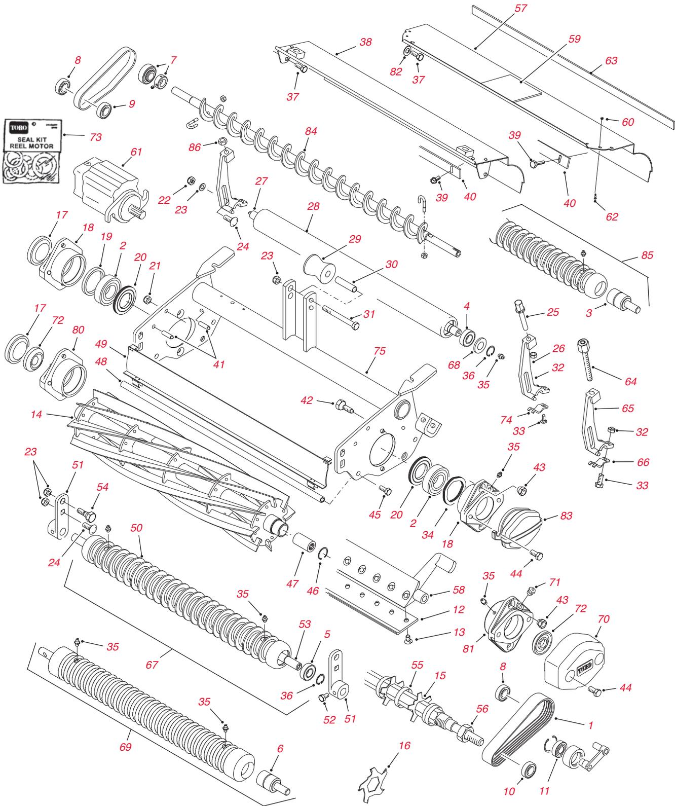
**4-Schrauben-Schneideeinheiten - Ersatzteile - Fortsetzung**
