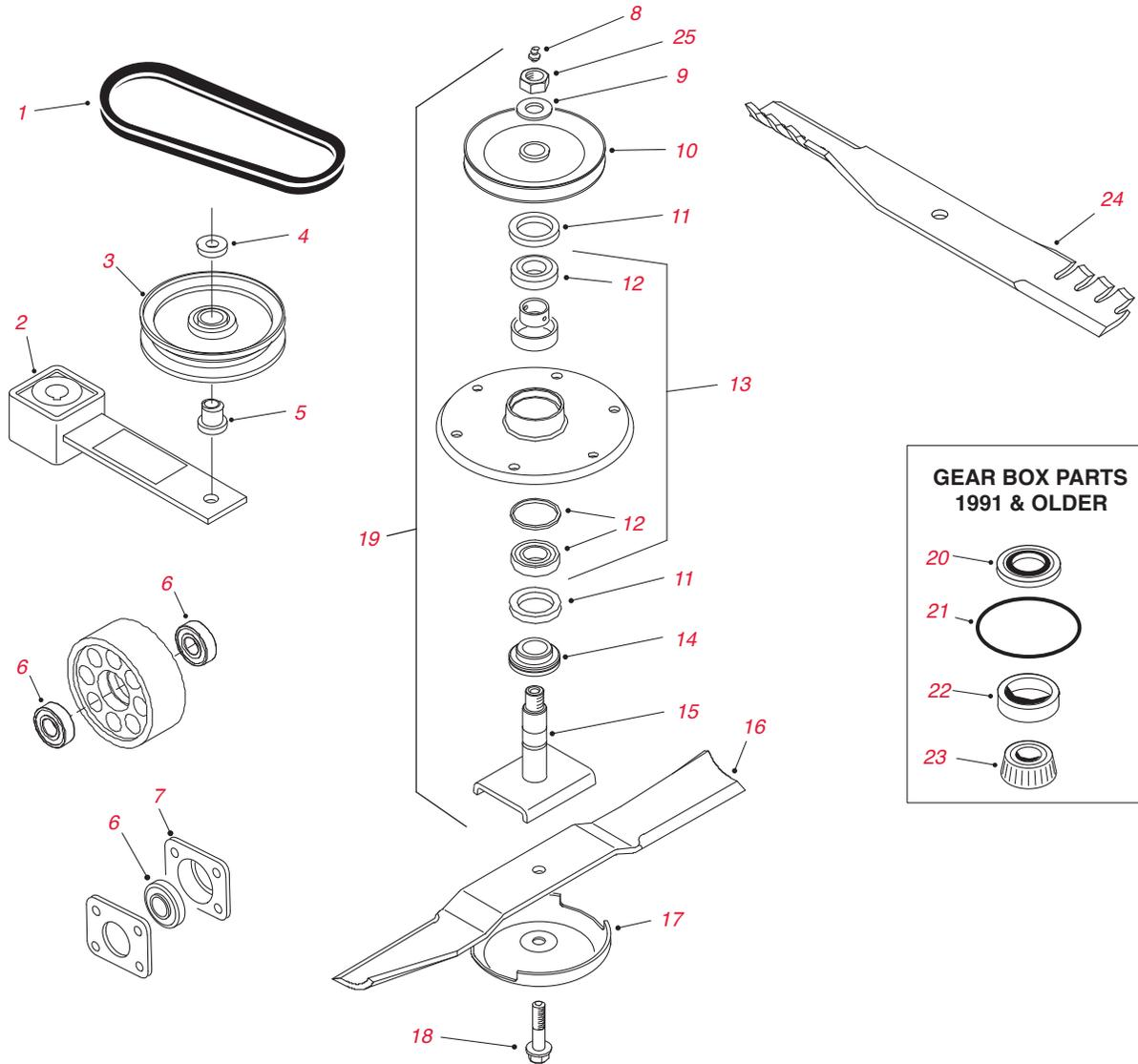
**Teile für Schneideinheitsspindeln & Spindelantriebe**
