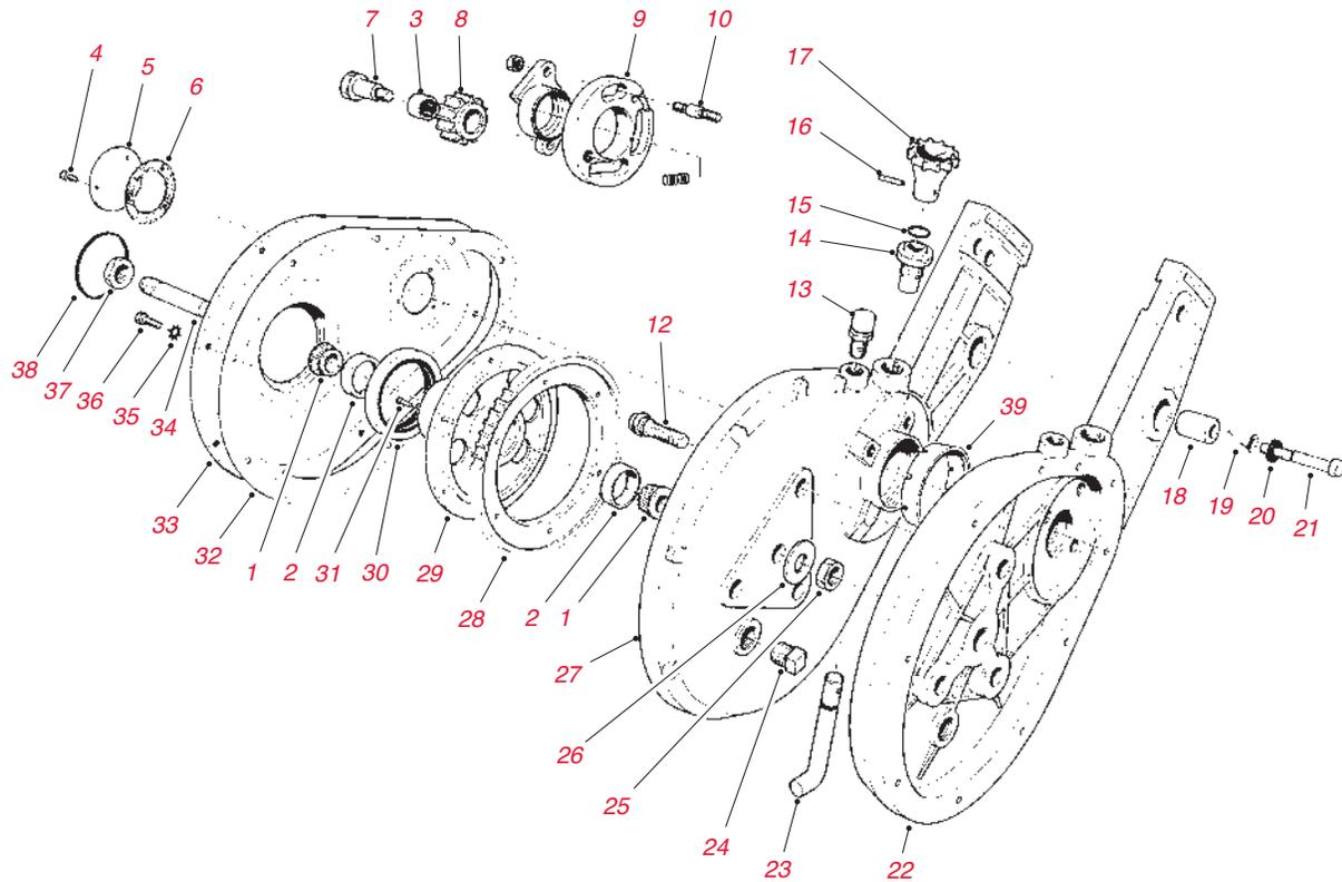
**Getriebe - Ersatzteile**
