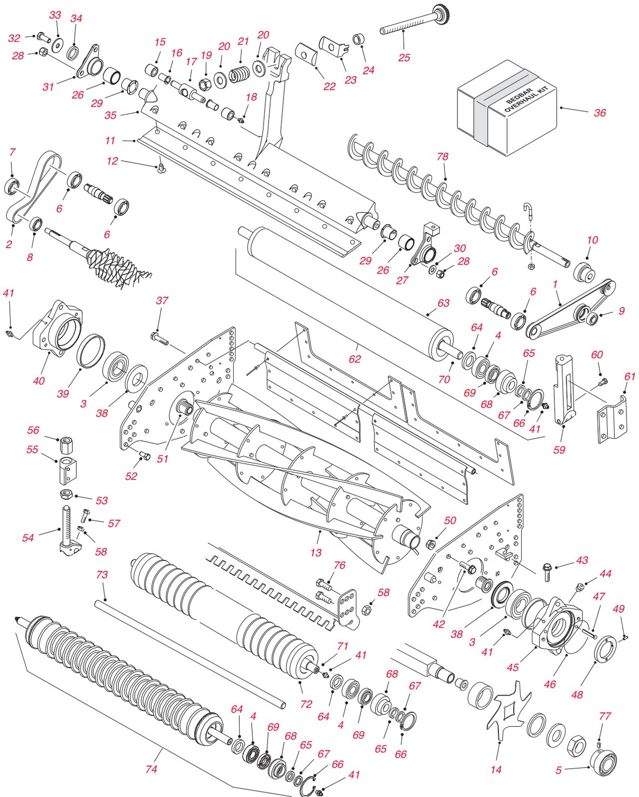
**SPA-Schneideinheiten (Single Point Adjust) - Ersatzteile - Fortsetzung**
