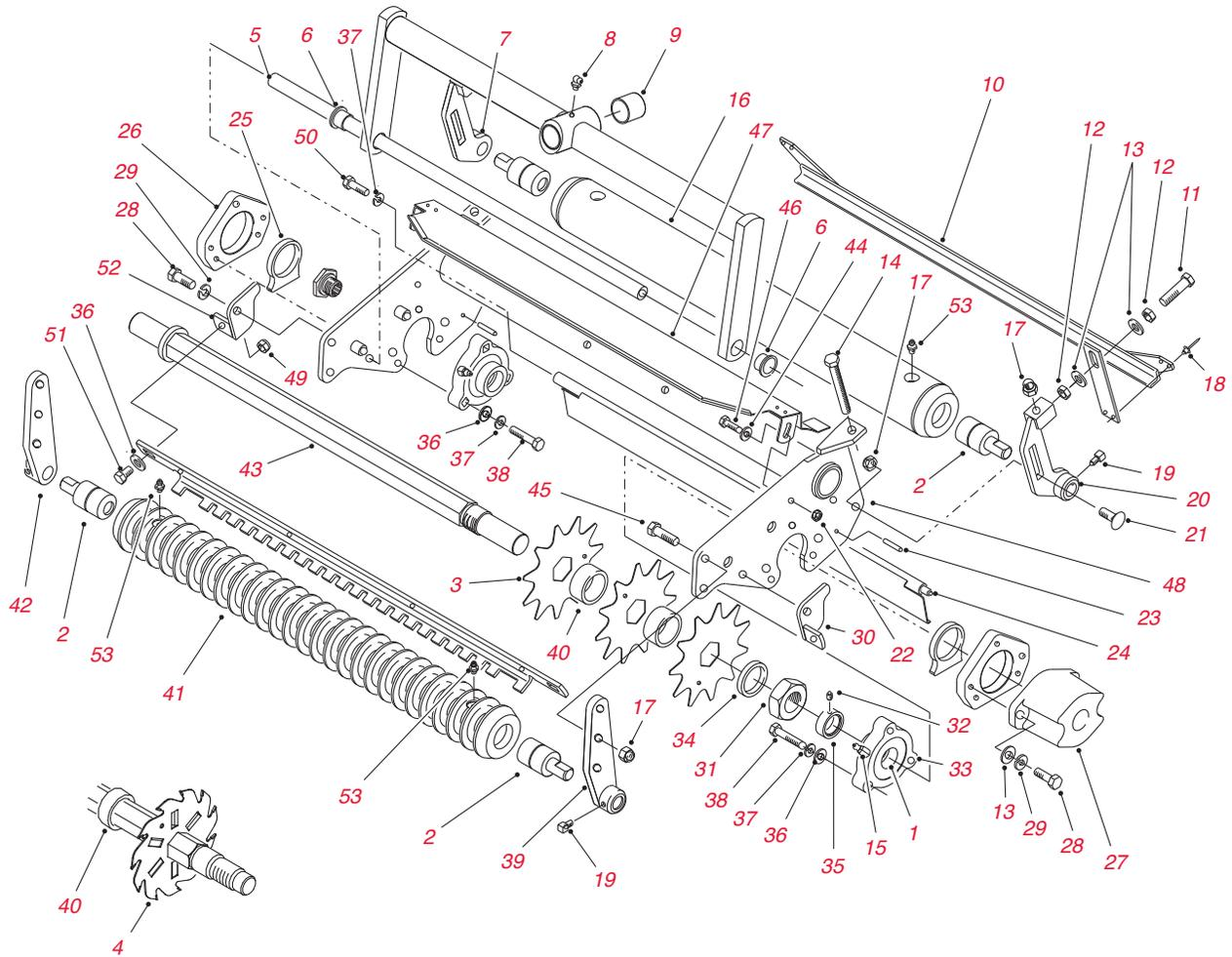
**Vertikutierspindel - Ersatzteile**
