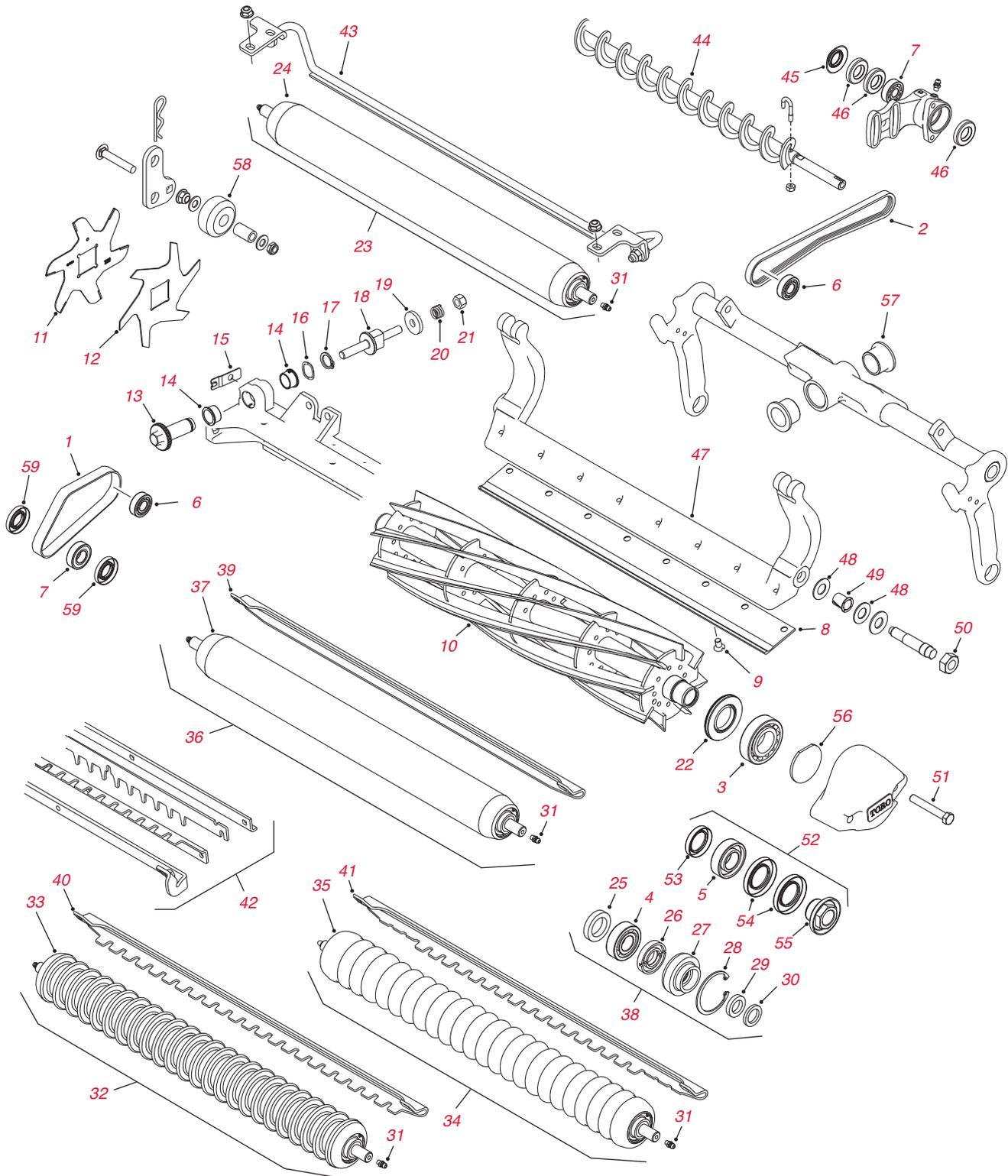
**DPA-Schneideinheiten (Dual Point Adjust) und Verticutter - Ersatzteile - Fortsetzung**
