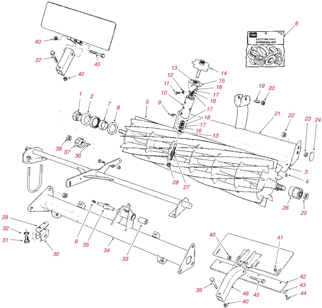
**Spindel und Untermesserträger - Ersatzteile**
