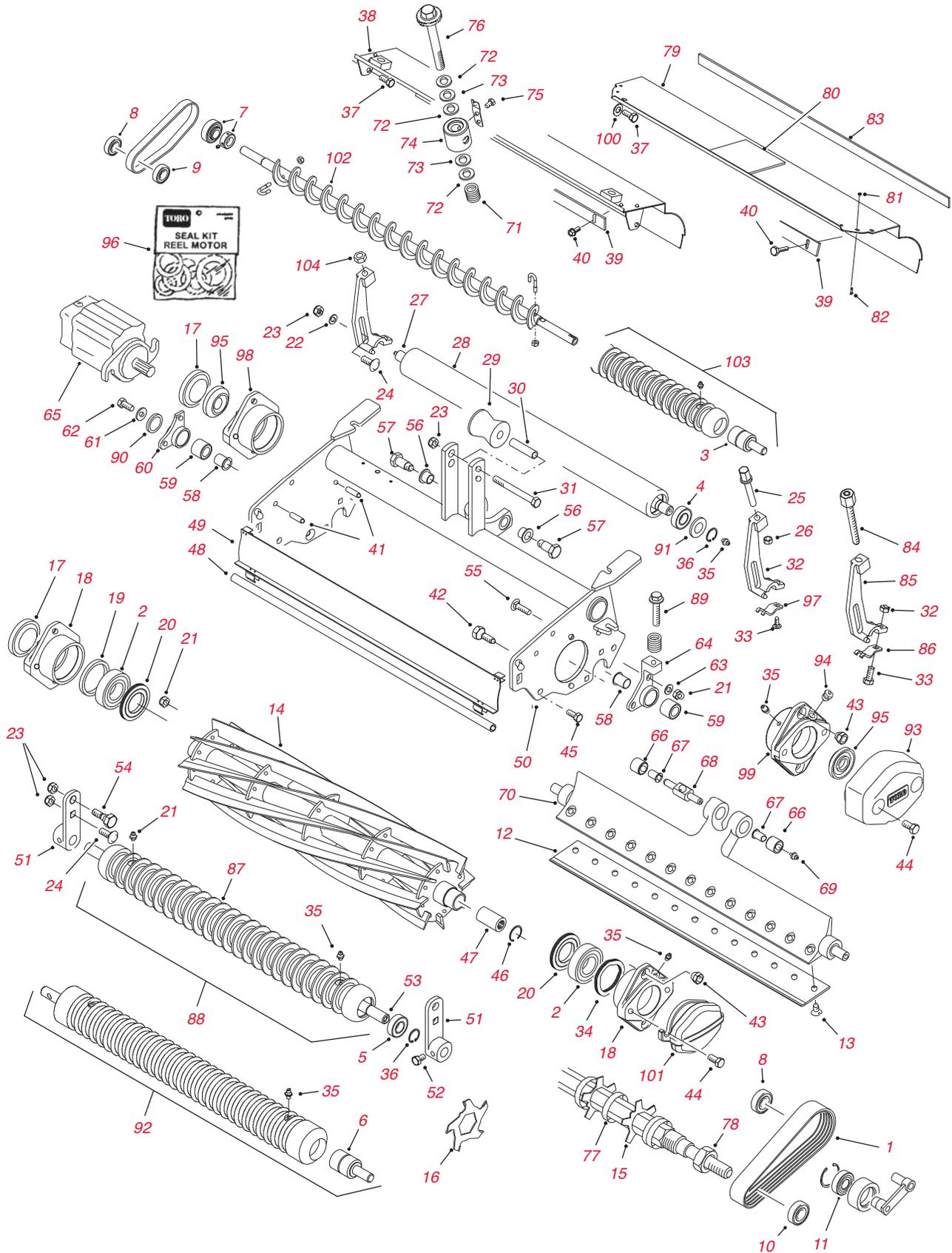
**SPA-Schneideinheiten (Single Point Adjust) - Ersatzteile**
