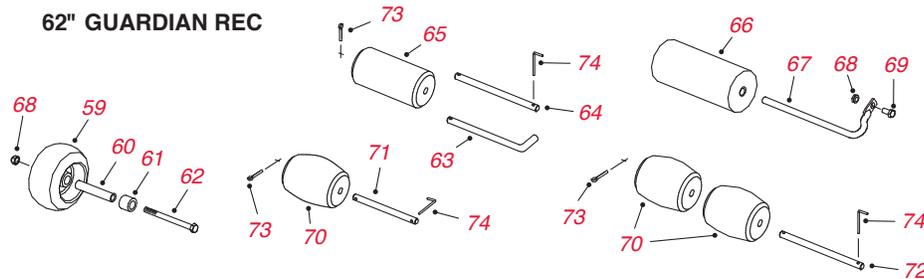
**Teile für Schneideinheitlaufräder & Rollen**
