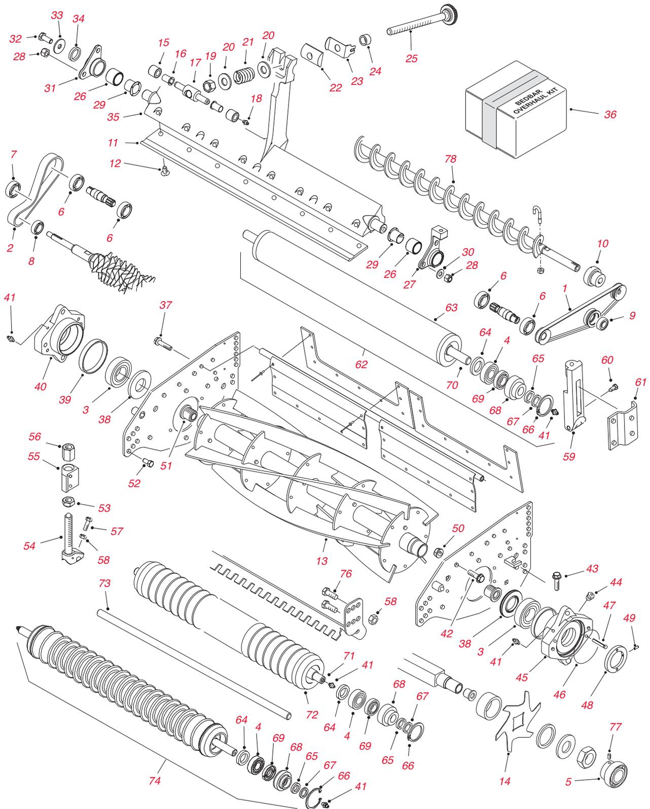
**SPA-Schneideinheiten (Single Point Adjust) - Ersatzteile**
