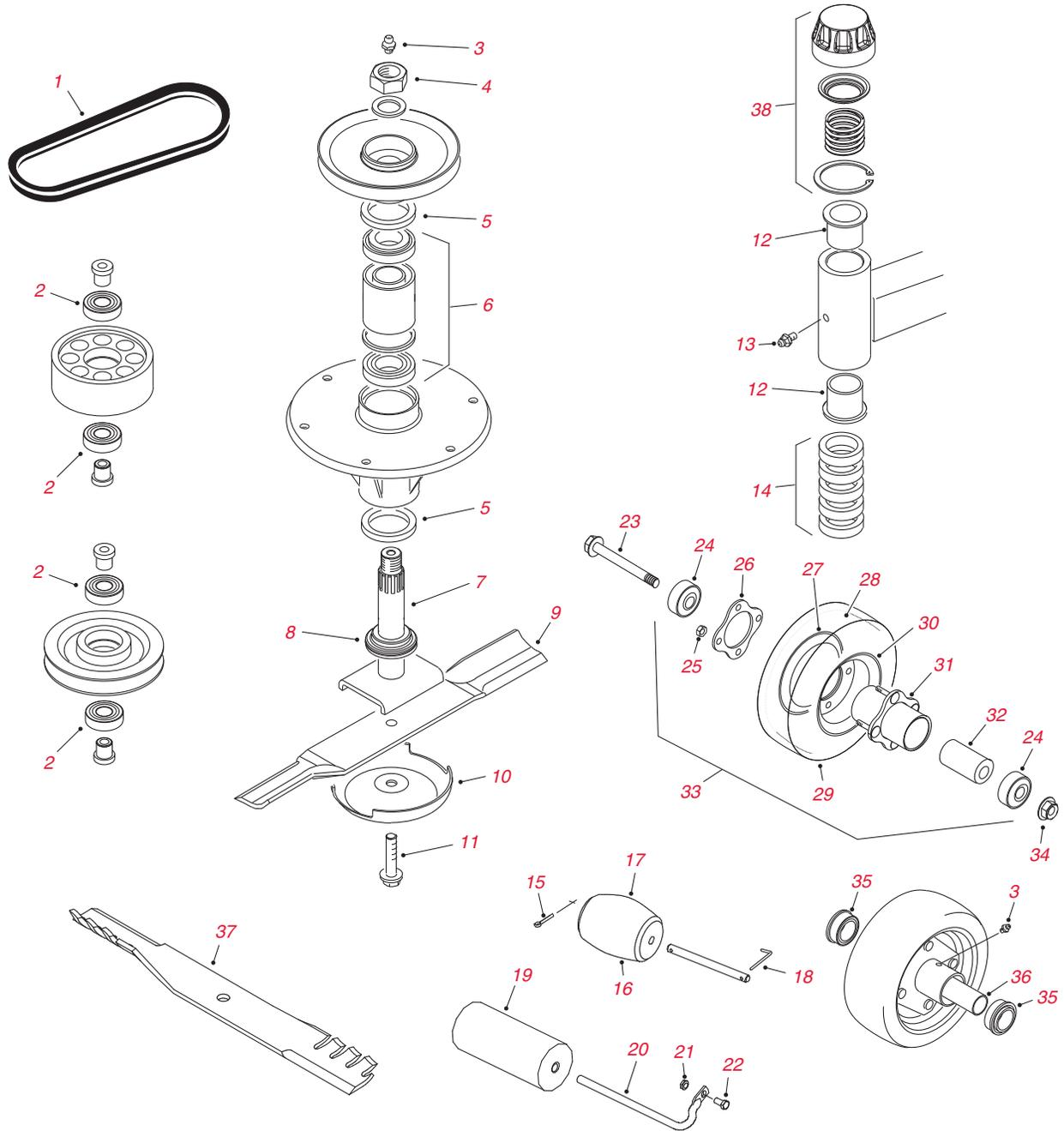
**Teile für Quadfloat-Schneideinheit (320 cm)**
