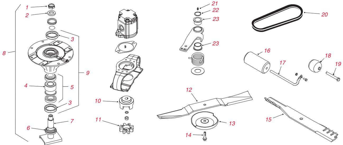
**Schneideinheit - Ersatzteile**
