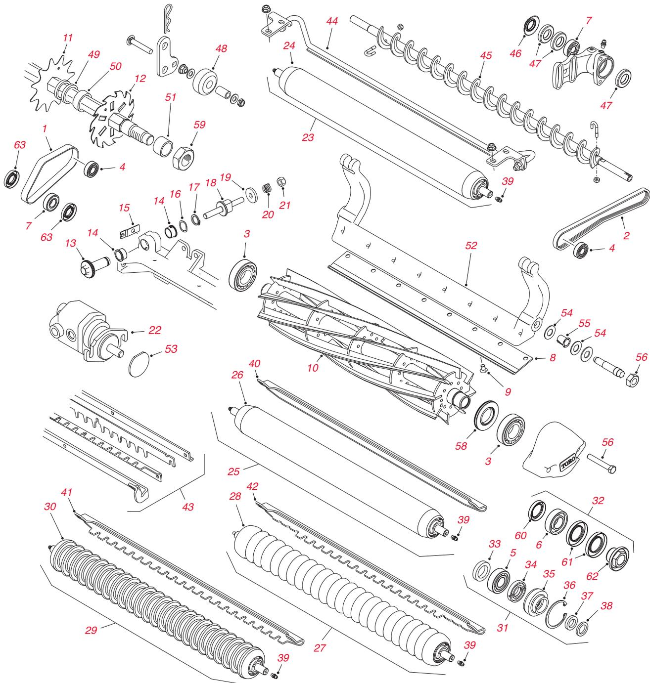
**Teile für Schneideinheiten & Verticutter**
