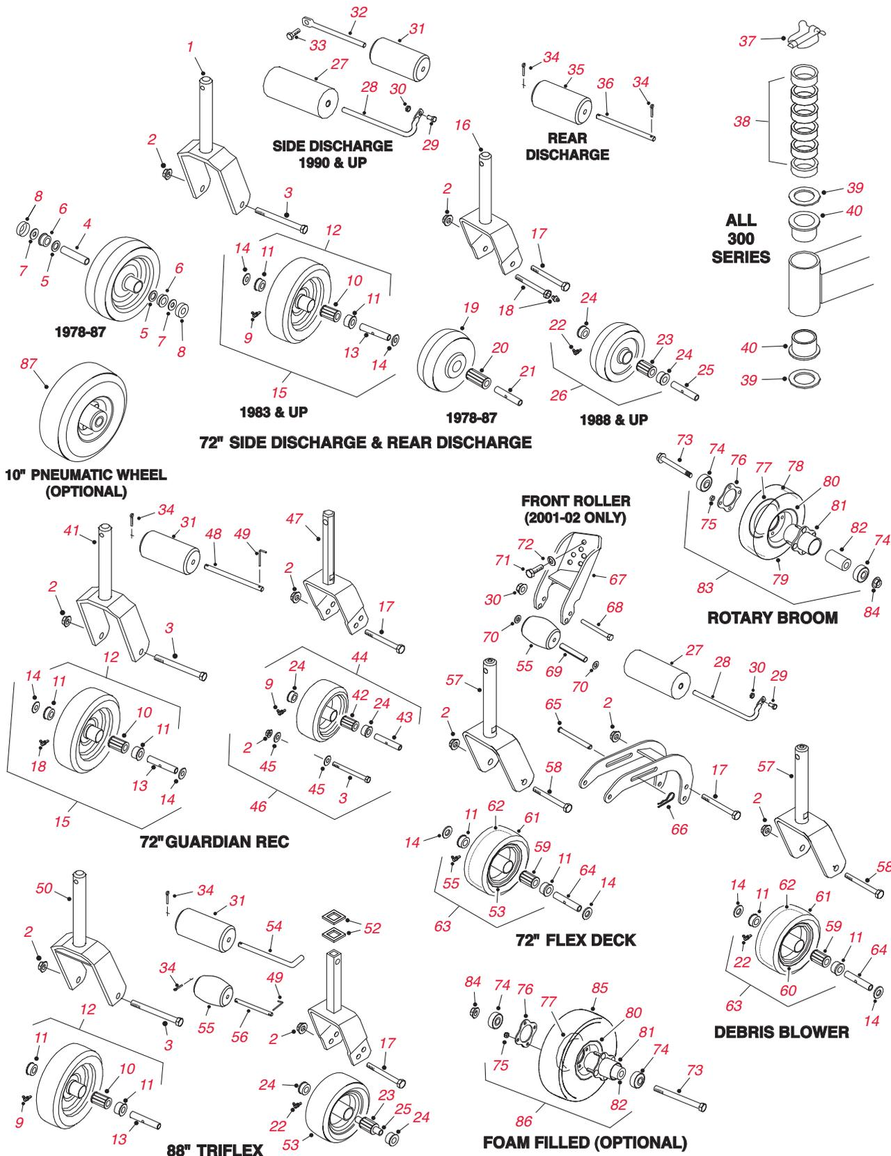
**Teile für Schneideinheitlaufräder & Rollen**
