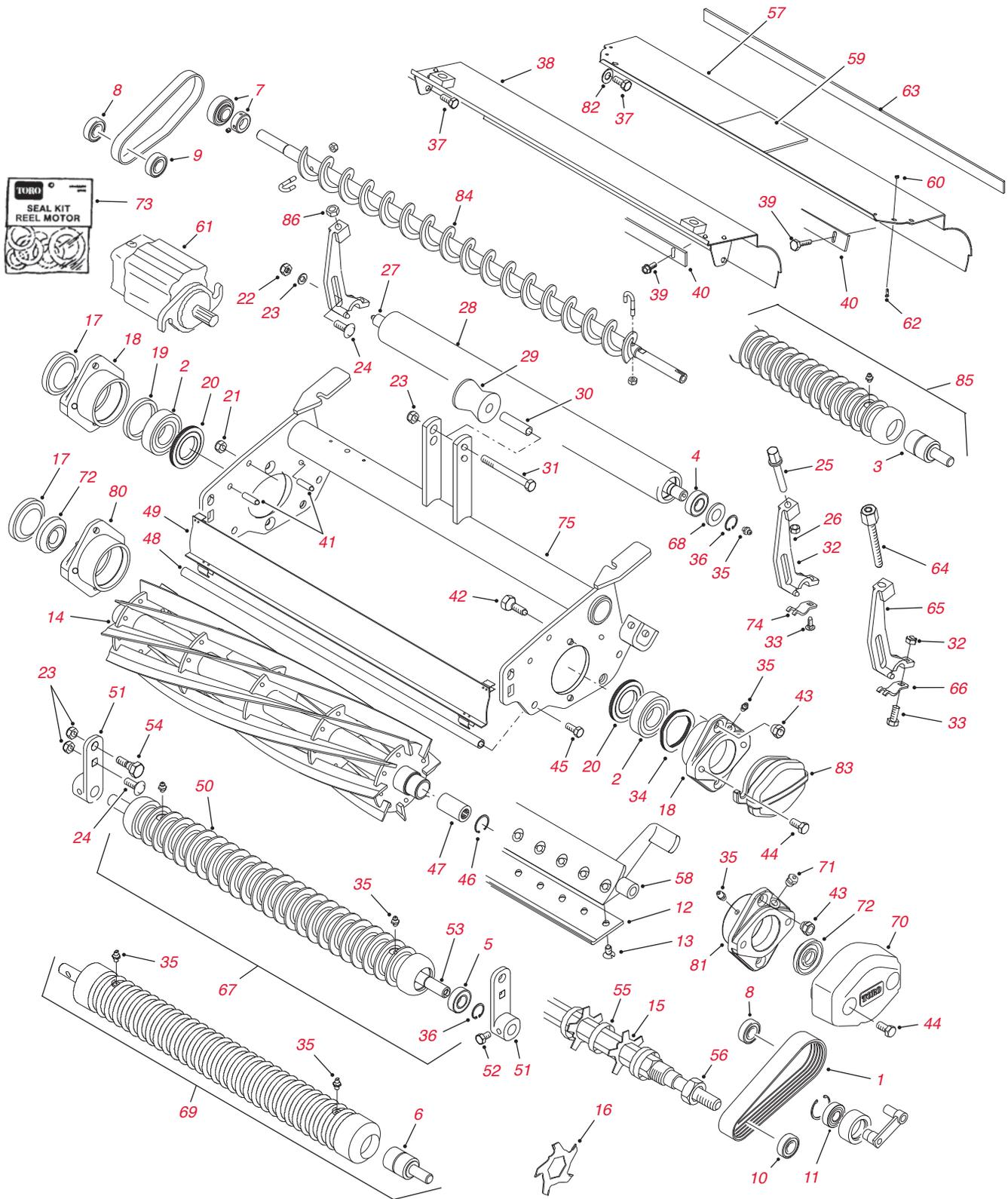
**Teile für 4-Schrauben-Schneideinheiten**
