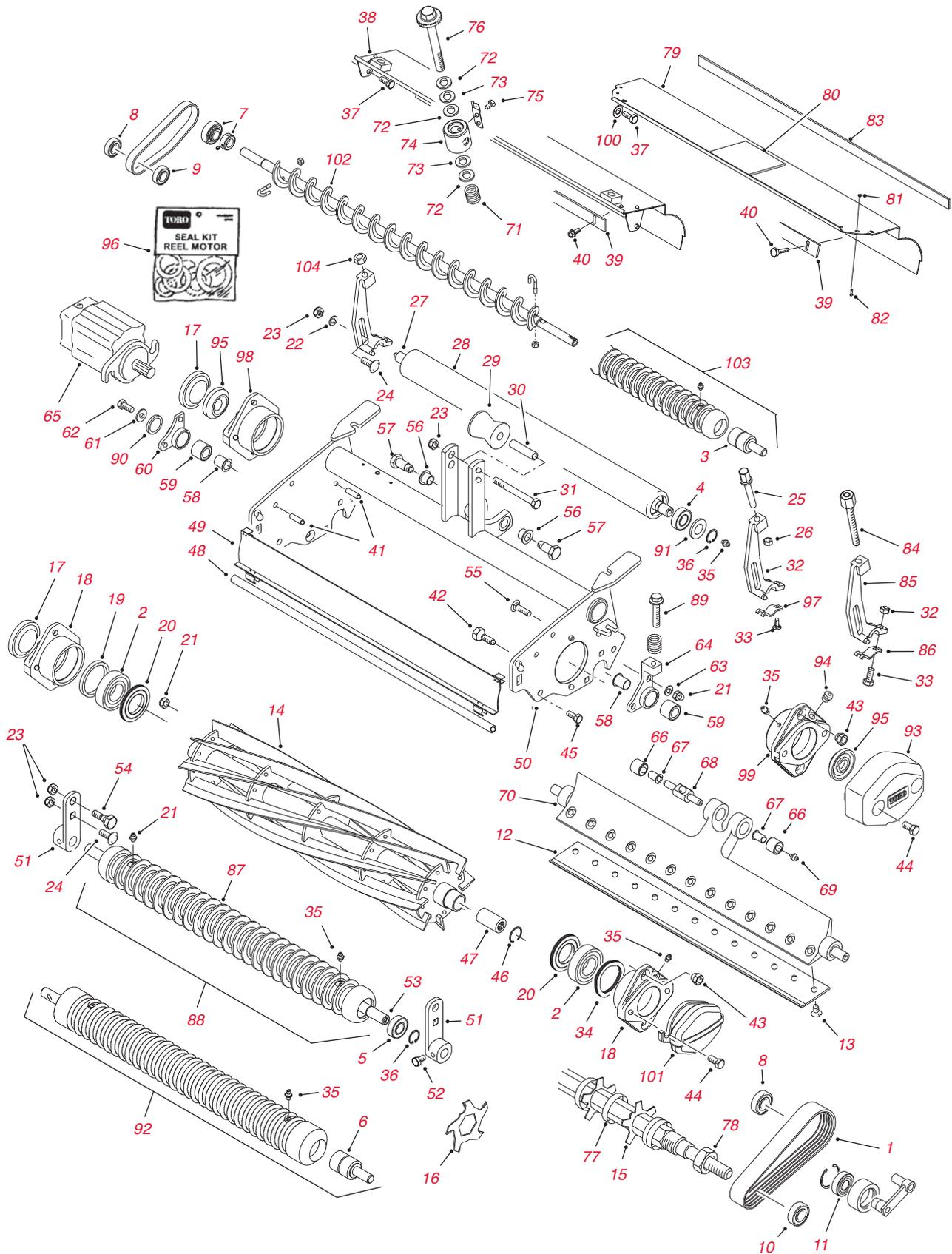
**SPA-Schneideinheiten (Single Point Adjust) - Ersatzteile - Fortsetzung**
