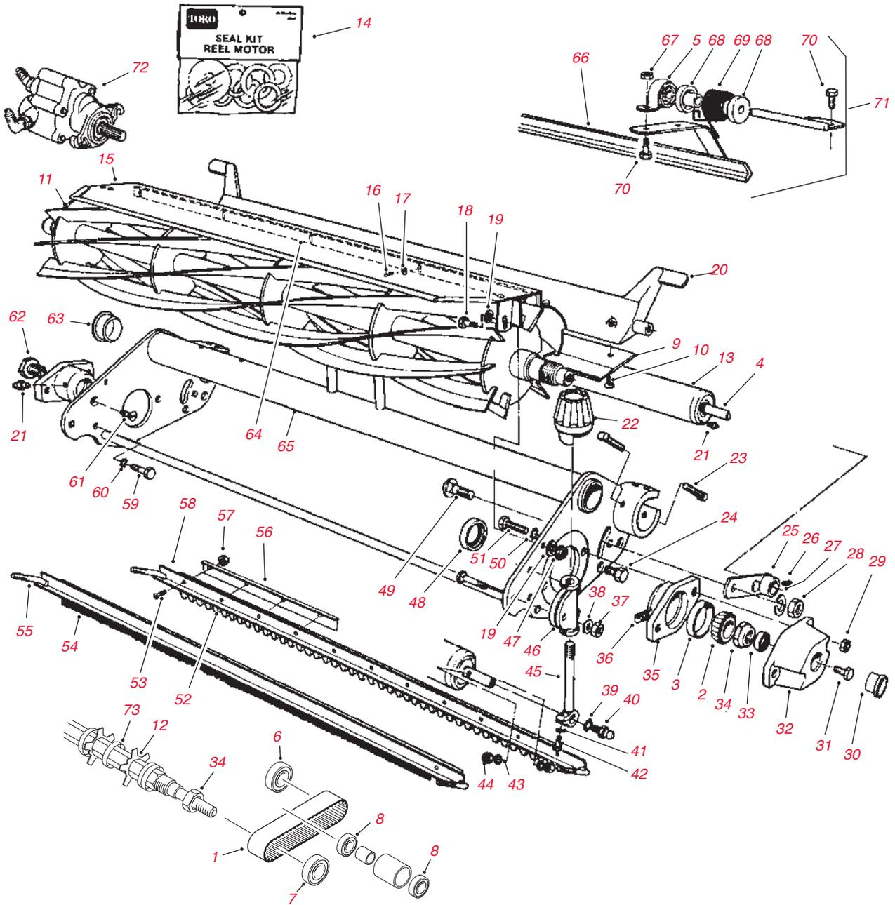
**Teile für 4-Schrauben-Schneideinheiten**
