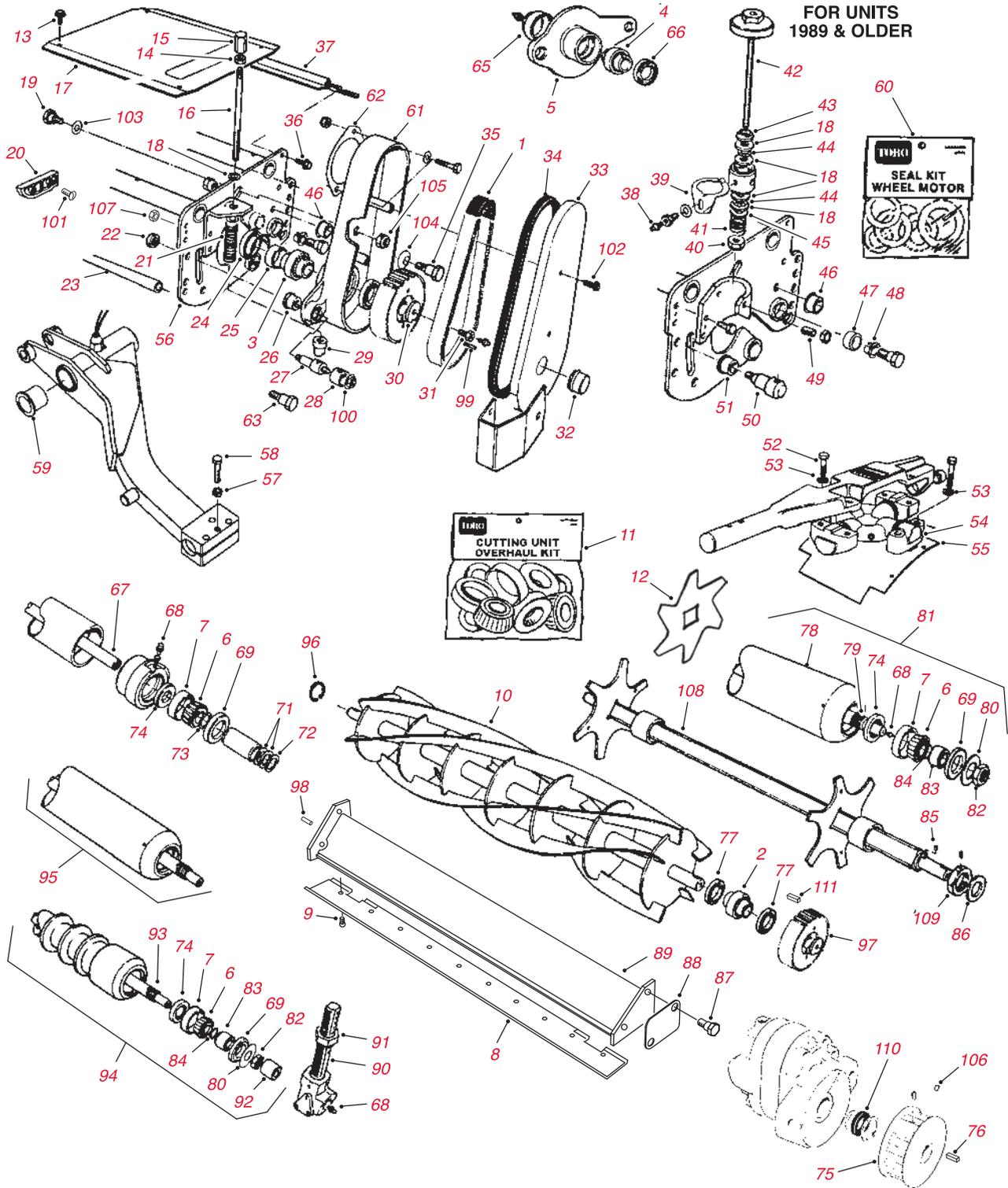
**Schneideinheit - Ersatzteile**
