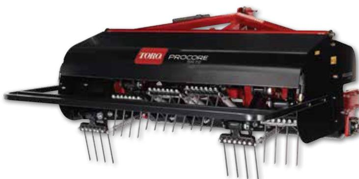
Die Serie ProCore SR bietet mit den Arbeitsbreiten von 122 bis 190 cm (48" bis 75"), maximalen Arbeitstiefen von 40,6 cm (16") und einem Lochabstand von 6,3 bis 15,2 cm (2,5" bis 6") die von Ihnen gewünschte Vielseitigkeit.
