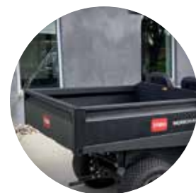
PIANALE DI CARICO DEL GTX IN ACCIAIO
