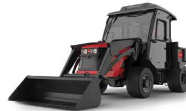
Cabina per tutte le stagioni con bracci di caricamento e benna
