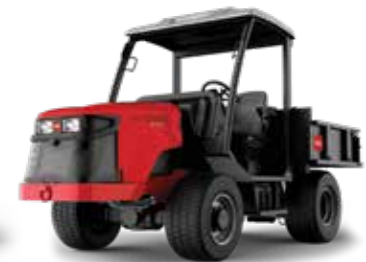
Toldo con plataforma de carga
