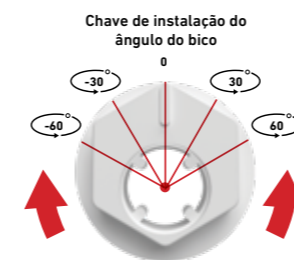
Bico de pressão INF34/FLX34 – (sistema imperial)
