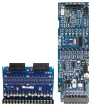
네트워크 VP ® 용 센서 입력 키트 VP-SEN-BRD-KIT 센서 보드 및 터미널 보드
