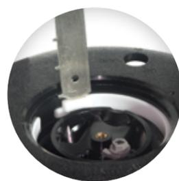
Outil d'extraction du circlip supérieur sur tous les modèles.
