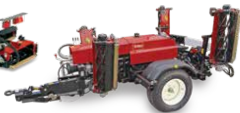
TM5490, 7490 – Schneideinheit mit 5 und 7 Spindeln
