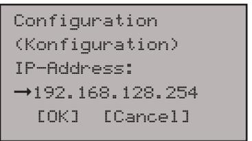
Die dritte Zeile zeigt den Wert an, der eingegeben wird. Diese Zeile wird an die Art des zu ändernden Parameters angepasst. Während der Bearbeitung zeigt ggf. ein blinkender Cursor an, welches Zeichen gerade verändert wird. Mit den Nach-oben- und Nach-unten-Pfeilen können Sie einzelne Werte ändern und mit den Nach-rechts- und Nach-links-Pfeilen navigieren Sie auf dem Bildschirm.
