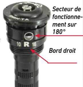
Cette méthode de réglage unique permet de pré-régler le secteur à la main ou avec un outil avant l'installation de la buse. Les indicateurs visuels permettent à l'utilisateur de régler rapidement le secteur d'arrosage sur l'angle désiré, entre 45 et 270°. La bande de réglage se règle à la main ou avec l'outil fourni. L'outil peut être commandé séparément sous la référence suivante : PRNTOOL
