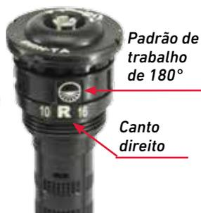
O método único de ajuste permite pré-configurar o arco à mão ou com uma ferramenta antes da instalação do bico. Os indicadores visuais permitem ao utilizador ajustar rapidamente o padrão de arco para o arco desejado de 45° a 270°. A tira de ajuste pode ser ajustada manualmente ou com a ferramenta pré-incluída. A ferramenta pode ser encomendada em separado como: PRNTOOL
