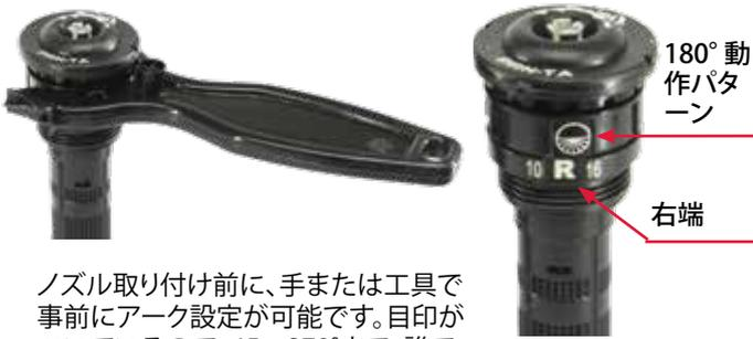
ノズル取り付け前に、手または工具で事前にアーク設定が可能です。目印がついているので、45-270°まで、誰でも簡単にアーク設定ができます。調整バンドは手で操作することも、付属の工具で操作することも可能。工具は別売も可能：発注コードはPRNTOOL
