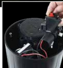
El compartimento Smart Access ofrece cabida para un módulo decodificador y empalmes.
