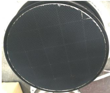
Figura 2 – Este filtro DPF está obstruido con PM debido a un funcionamiento prolongado del motor a baja carga, un tiempo de ralentí prolongado a bajas revoluciones o una falta de mantenimiento.
