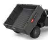
Elevación eléctrica de la carcasa
