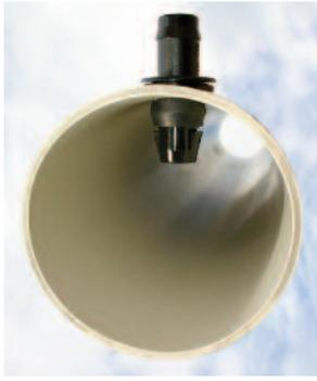
La instalación del conector Xpando Take-Off se realiza insertando el sello de refuerzo en la tubería de PVC o de Polietileno de alta densidad (HDPE), para después embonar la lengüeta abatible dentro del Sello. La lengüeta se abate al momento de entrar, sin dañar el sello.
