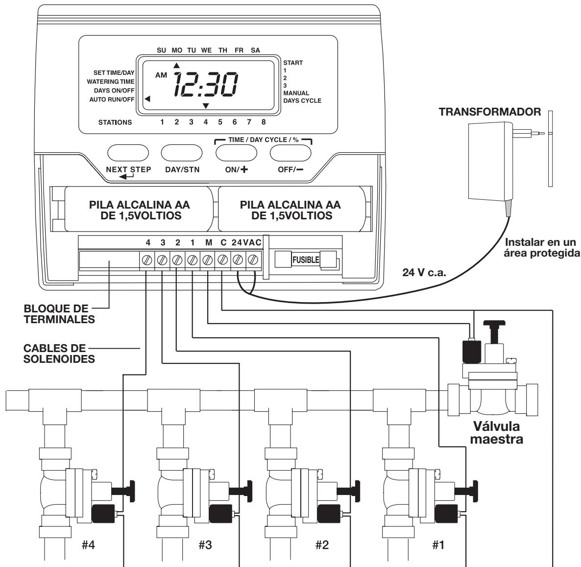
Retire la tapa inferior. Instale la unidad sobre la pared usando una ranura y un orificio fijo dentro de la ranura para las pilas. Conecte los cables de los solenoides al bloque de terminales. Conecte un cable de cada solenoide al terminal rotulado "C" - COMMON (Común). Conecte el otro cable de cada solenoide a su número respectivo en el bloque de terminales. Conecte los cables del transformador al bloque de terminales rotulado 24VAC.
