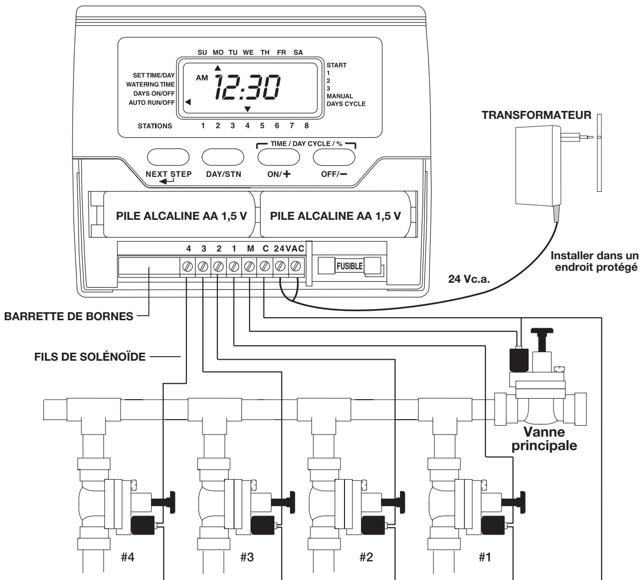
Enlevez le couvercle du bas. Montez l'appareil au mur en utilisant une fente et un trou fixe à l'intérieur du compartiment à pile. Connectez les fils des solénoïdes à la barrette de bornes, en raccordant l'un des fils de chaque solénoïde à la borne « C » (Commun) et l'autre fil au numéro de borne correspondant au solénoïde en question. Branchez les fils du transformateur à la borne marquée 24VAC (24 Vc.a.).
